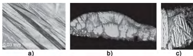
Figura 3. Microstructurile aliajului cu memorie a formei Cu-Zn-Al, arătând structura martensitică a aliajului masiv (a), creșterea columnară în bandă (b) și detaliu cu structura martensitică înăuntrul grăuntelui din bandă (c) /
