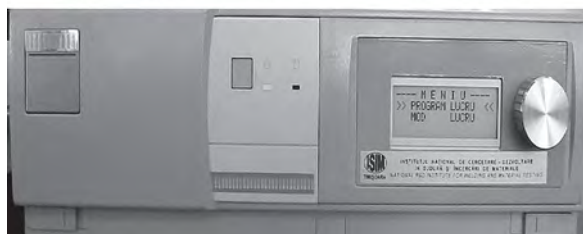
Figura 2. Echipamentul de sudare cu ultrasunete controlat de calculator, realizat pentru programele experimentale de sudare /
