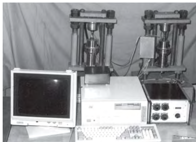
Figura 9. Aspectul general al instalației ISIM de încercare la oboseală termică [10]/
