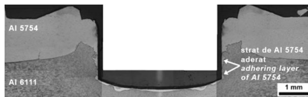
Figura 2. Mișcarea descendentă a stratului aderent al tablei superioare (AA 5754) odată cu rotirea elementului activ rotitor cilindric, precum și pătrunderea în materialul tablei inferioare AA6111/
