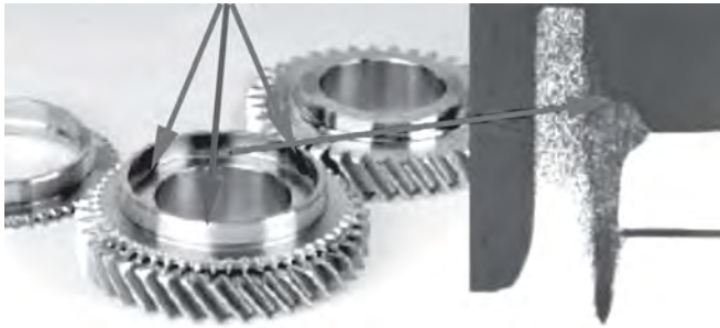
Figura 17. Producția de serie a roților dințate a fost îmbunătățită cu ajutorul tehnologiei multifascicul: reducerea deformațiilor prin încălzire simetrică și suduri înguste/ Figure 17. Series production of gears is being improved by multi-beam technologies: reduction of distortion by symmetric heat input and narrow welds.
