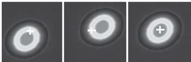
Figura 6. Imaginile din stânga și centru arată mișcarea fasciculului sub reticul la defocalizarea fasciculului. Imaginea din dreapta reprezintă fasciculul defocalizat care stă în poziția focarului (reticul)/
