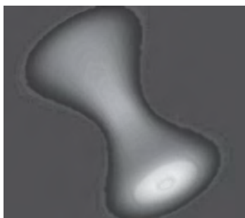
Figura 2. Imaginea 3D a unui fascicul focalizat, tonurile de gri reprezintă mărimea densității de putere a electronilor (comprimită de 100x pe direcția x)/ Figure 2. 3-D image of the beam focus. The colors represent the power density of electrons (compressed 100 x in length)
