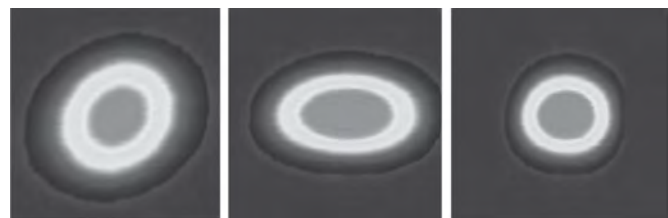
Figura 7. Imaginile din stânga și centru arată astigmatismul unui fascicul ușor defocalizat. Imaginea din dreapta arată distribuția de putere corectată a unui fascicul circular./
