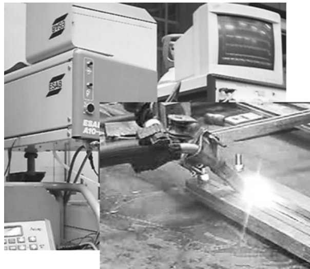
Figura 1. Stand experimental sistemului de prindere și dispozitivul de deplasare al capului de sudare [7, 8]/
