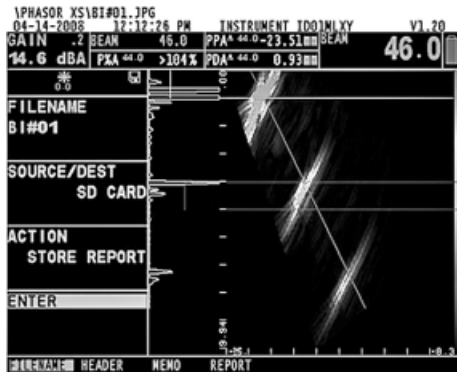
Figura 4. Raportul salvat pe memory card pentru o regiune bună de material compozit, 5 mm grosime, phased array plasat pe o linie de întârziere /
