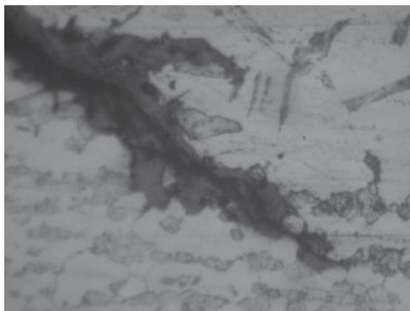
Figura 4. Fisură – Sudură C12, la placaj, dintre virola 2 și virola 3, cupon 1, proba M12/
