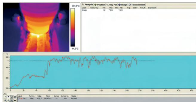
a) R3 - Exp. 1 ( $T_{R3 \text{ max}} \sim 500^{\circ}\text{C}$ ;  $T_{R3 \text{ med}} \sim 460^{\circ}\text{C}$ )
